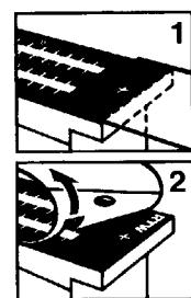
Klebefolie mitsamt der horizontalen Skala an einer Ecke vorsichtig anheben und flach in Pfeilrichtung abziehen. Nicht gewaltsam hochreißen! Die vertikale Skala wird sichtbar. Gerät ist montagefertig.
